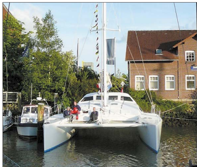
«Merlin» vom Typ «Nautec 140» wurde 1991 in der Baltec-Werft gebaut, ist 14.5 Meter lang, 8.5 Meter breit, mit einem Tiefgang von 1.2 Metern.
