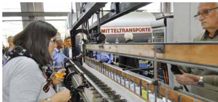
Vielbewunderte «Chlüpperli-Maschine»: Die Saurer Handstickmaschine – bis 1905 in Arbon seriell gebaut – hat zurück an ihren Produktionsstandort gefunden.
