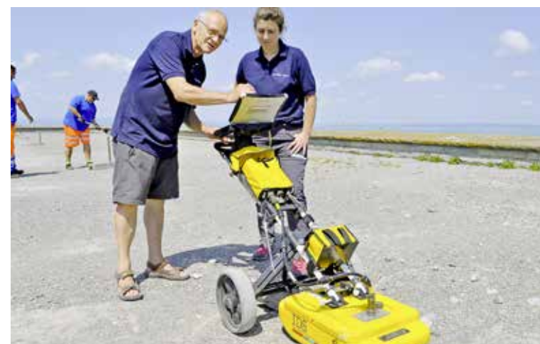
Geophysiker Edi Meier und seine Mitarbeiterin fahren mit dem gelben Gerät schachbrettartig den Aussichtsplatz ab. Dabei «röntgen» sie den Untergrund und kommen zum Schluss: «Hier besteht keine Einsturzgefahr.»
